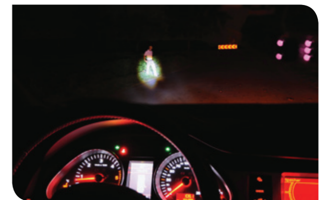
Bringt Licht ins Dunkle: Das Fahrerassistenzsystem markiert Personen und Wild und hilft so, Unfälle zu vermeiden
