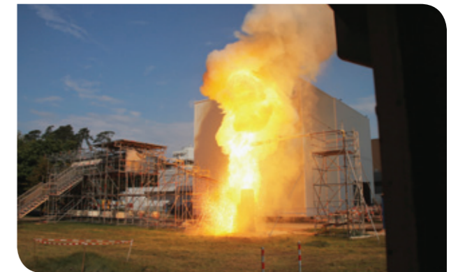
Simulation einer Kernschmelze in MOCCA-Anlage
